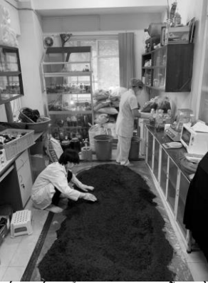
Sản xuất chế phẩm xử lý ô nhiễm dầu bằng vi khuẩn tạo màng sinh học trên than sinh học có nguồn gốc từ trấu tại phòng thí nghiệm.
